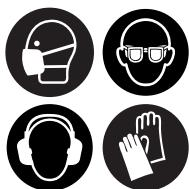
Uygun kişisel koruyucu donanımlar kullanın: Kulaklık, koruyucu gözlük, toz oluşturan çalışmalarında toz maskesi, kaba malzemelerle çalışırken ve alet değişiminde koruyucu eldivenler.
